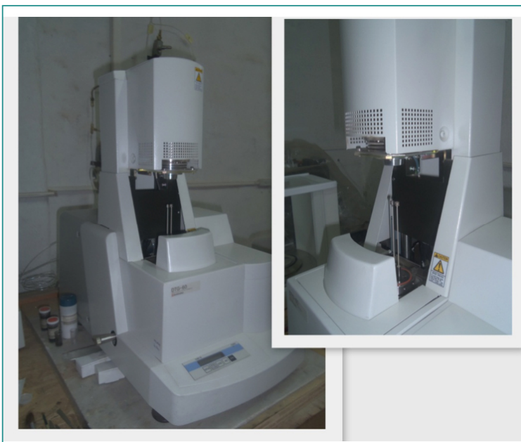
Balanza termogravimétrica con las compuertas abiertas, donde se colocan las muestras de carbón.
